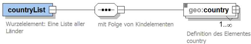
Abbildung 64: Die obige Schemadeklaration in grafischer Darstellung. Die Zusammenhänge werden leicht ersichtlich, Details für ein Element können bei Bedarf einfach „aufgeblättert“ werden.
