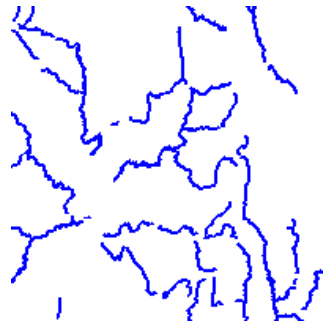
Abbildung 72: Durch einen LineSymbolizer wird die Darstellung durchgezogener Linien der Breite 2 und der Farbe #0000ff (blau 84 ) definiert.
